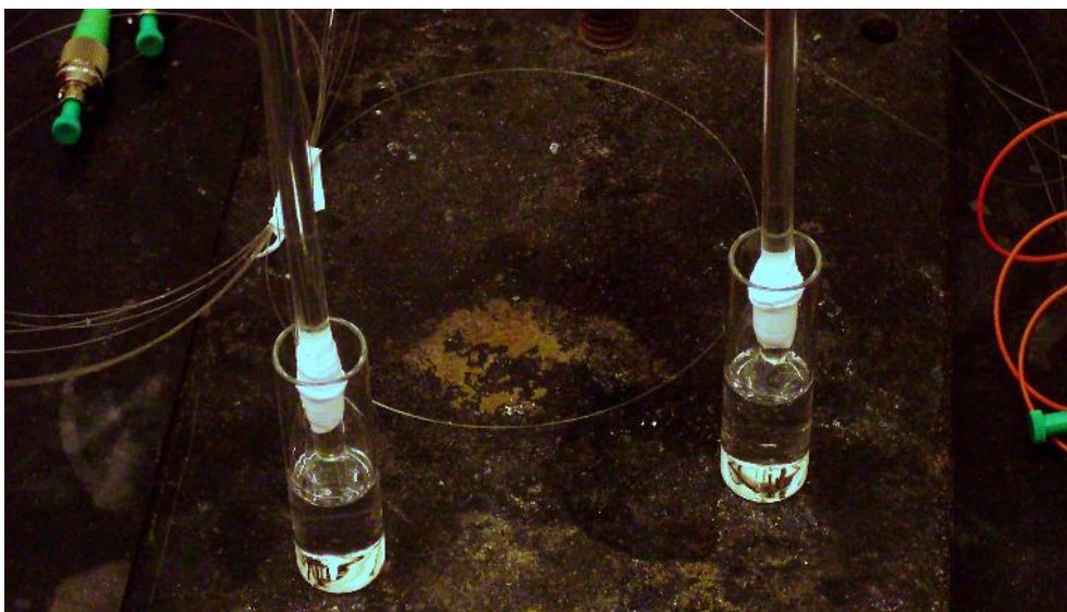
Figura 14: Fibras ópticas imersas na solução etanólica 10%(v:v) de MPTMS.
