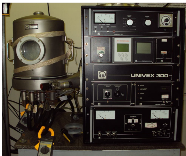
Figura 10: Câmara de vácuo onde são depositados os filmes finos de metal na face das fibras ópticas.
